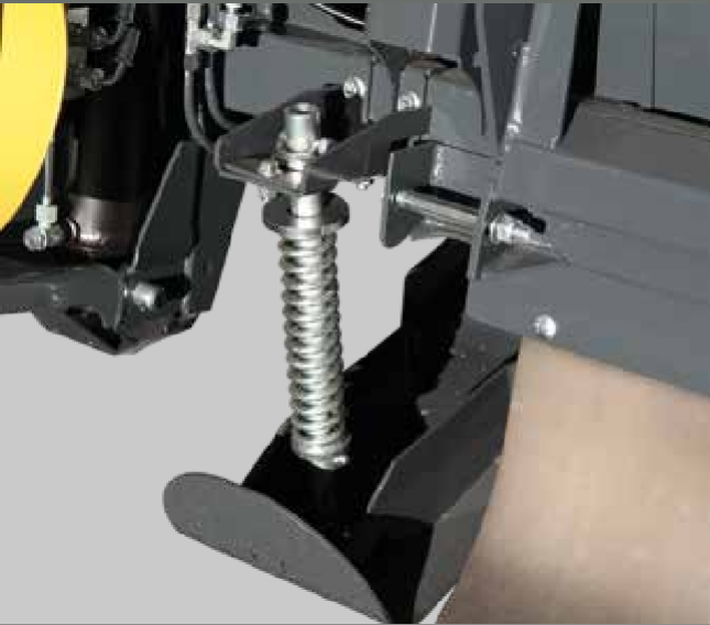
stalkクラッシャー（オプション）は、刈り株の損傷からタイヤを保護します。
