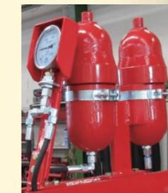
二つのリンクしてあるアキュムレーターが油圧ゲージをコントロール。起伏に合わせて油圧シリンダーが伸縮し、ローラーが圃場に追従することで均一な鎮圧を行います。
