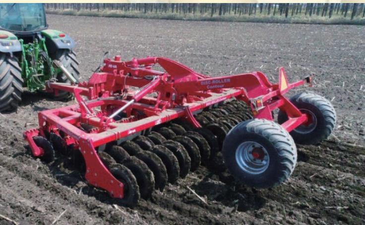
油圧リモコンで上下する新設計の大口径セーバーディスクと丈夫なフレームは、10km/h~15km/hの超高速作業を実現します。
