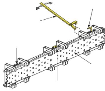
\* 図のレバーで畝間を調整します。
