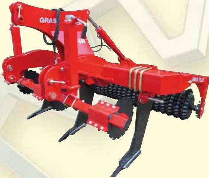
タインブレードはブラケットで固定されている為作業形態、トラクターの馬力に合わせてスペーシングの調整、本数の増減が可能。
