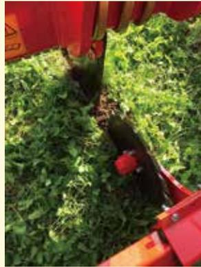
直径400mmのディスクコルター、深度設定はハンドルによる簡単調整。
