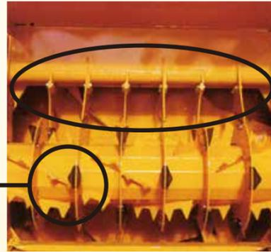
石などの異物の混入に強い設計でナイフ交換などにも時間を要しません。過度の負担にはPTOシャフトクラッチと機械側シェアボルトの2重のセーフティ対策で機械を守ります。
