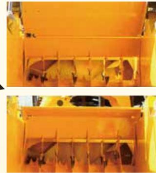
あらゆる材料に対応する可変式油圧コームによって材料をスムーズにフライホイールチャンバーに供給します。
