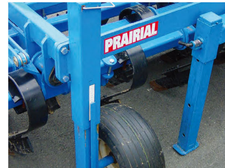
標準装備のハンドルスクリュウ式深さ調整ホイールゲージ
