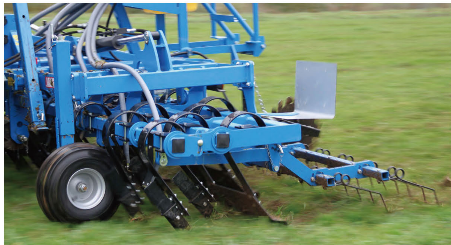
標準装備のハンドルスクリュウ式深さ調整ホイールゲージ
