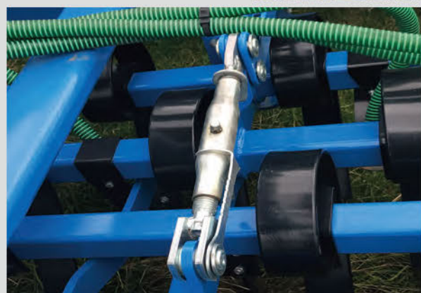
ターンバックルによるナイフ角度無段階調整
