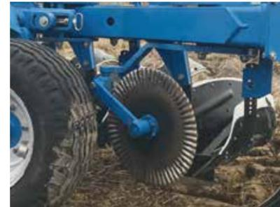
径508mmのリアディスクコルターが表面残渣物をしっかりと切断し、すき込み反転性能を補助します。
