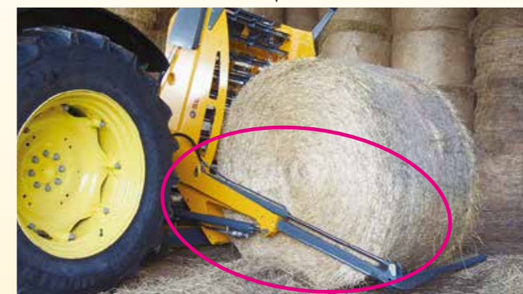
油圧コントロールのアームはベールの径に合わせて簡単に長さを調整できます。
