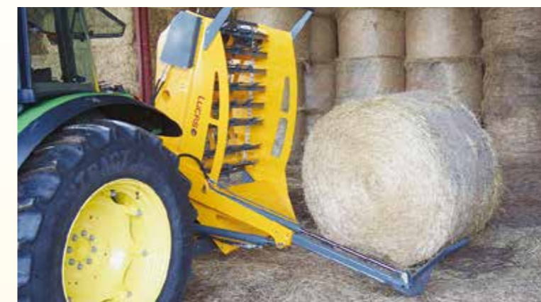
本機は90°チルト(傾く)するので積み込みが容易です。
