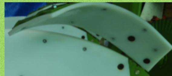
トラッシュボードは乾燥した軽い土質や、早い作業スピードでの土の跳ね上りを抑え効果的に反転を助けます。(T仕様には標準で装備されています。)
