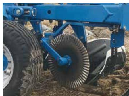
径508mmのリアディスクコールターが表面残渣物をしっかりと切断し、すき込み反転性能を補助します。
